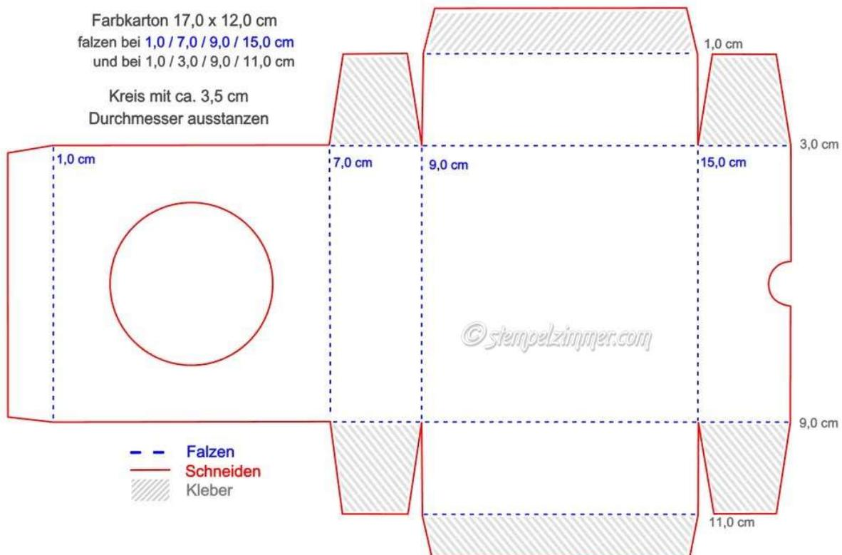
2. Das Innenteil (die Halterung für das Auge) lt. Zeichnung zuschneiden und falzen.
